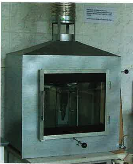
Fot. 2. Widok stanowiska do badania reakcji na ogień zgodnie z normą PN-EN ISO 11925-2:2010, wykorzystywane w CNBOP-PIB
