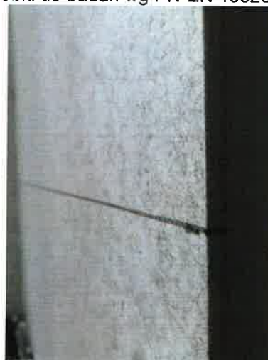
Fot. 5. Zewnętrzna krawędź długiego skrzydła 500 mm nad podłogą wózka – bez podkładu
